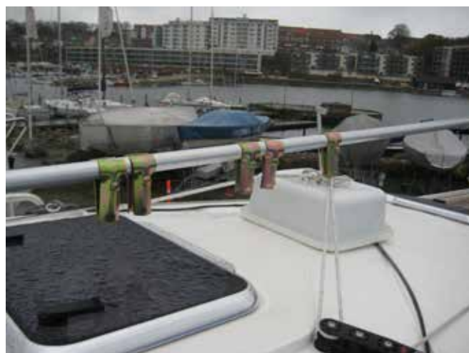
Alle t-beslag monteres fra enden og på hver side af samlebeslag.
