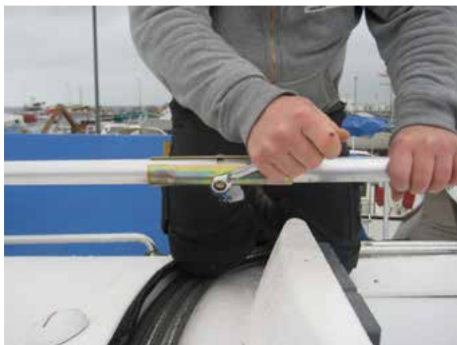
Spændes med bræddebolthoved opad.
