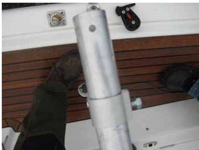
Spær monteres og spændes ved septer.
