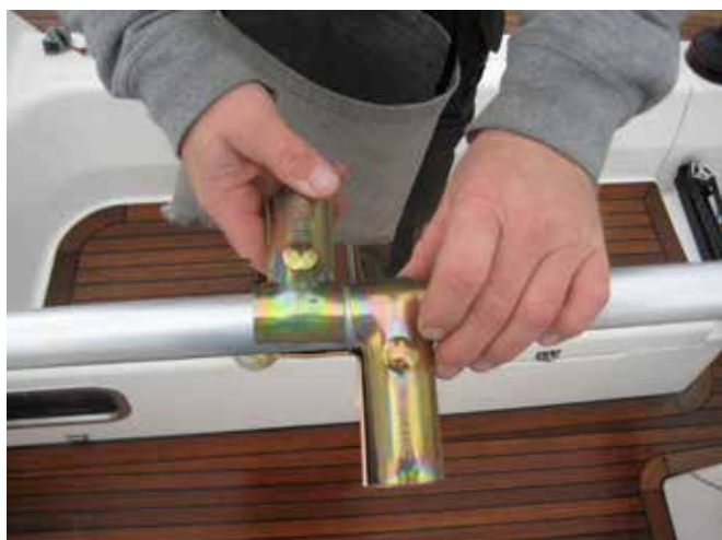
T-beslag på rygning. Hoveder på bræddebolteopad mod presenning.
