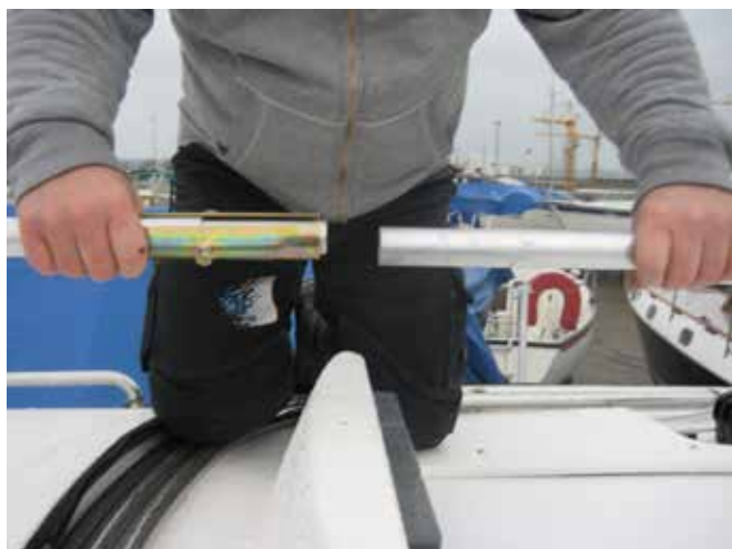
Rygning samles. Husk t-beslag inden.
